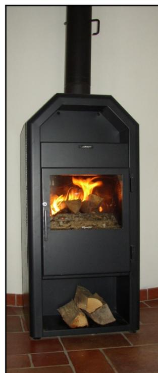
Der für Passivhäuser entwickelte Kaminofen gibt nur ¼ Wärme (2 kW-Heizleistung) an den Raum, aber ¾ (6 kW-Heizleistung) an den Speicher ab. Somit kann der Wohnbereich nicht überhitzen.
